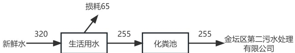
**图 2-1 项目实际水平衡图 (t/a)**
