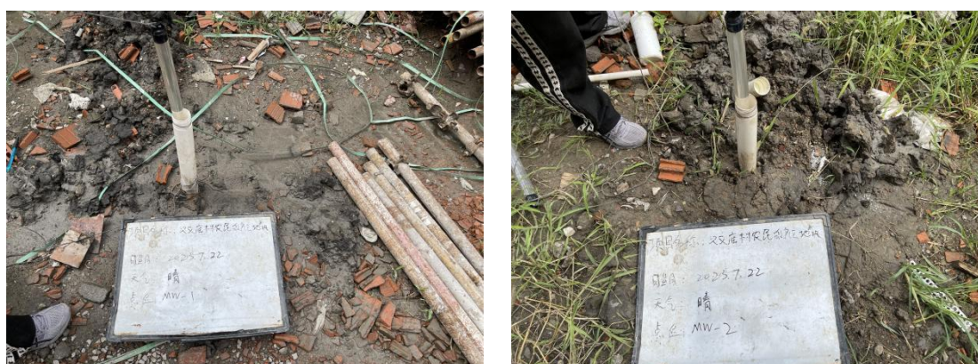
图 8.1-2 本次土壤污染状况调查现场洗井照片
